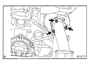
9. INSTALL TURBINE OUTLET ELBOW
