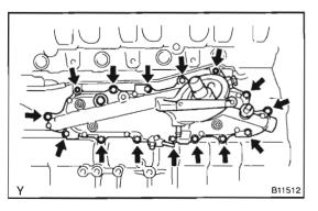
4. INSTALL OIL COOLER AND OIL COOLER COVER AS-SEMBLY
